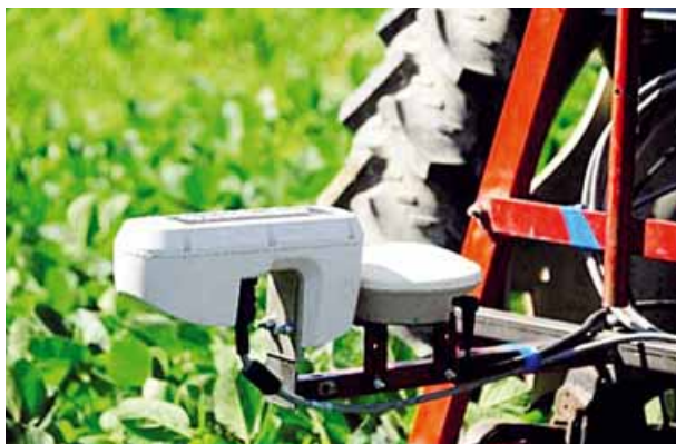
Foto 1 GreenSeeker installato su trattore
